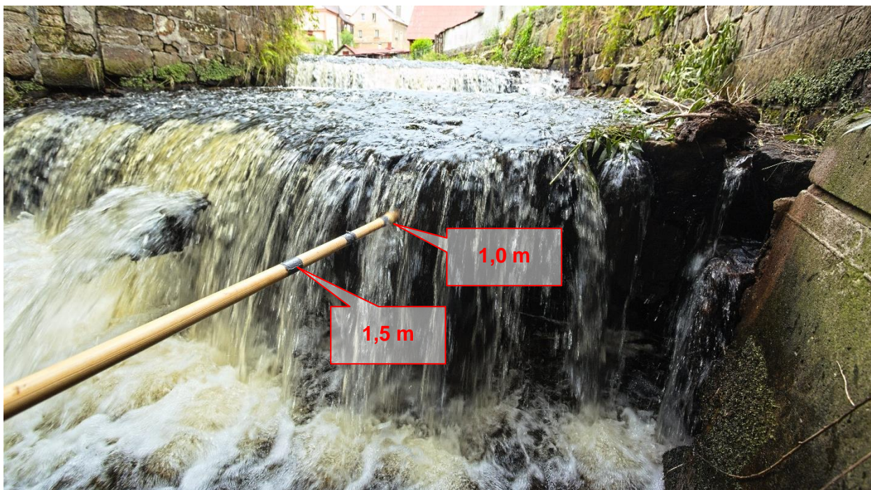
Obrázek 14 Zastrčená tyč pod přelivnou hranu dolního stupně vodorovně do hloubky 1,0 m.
