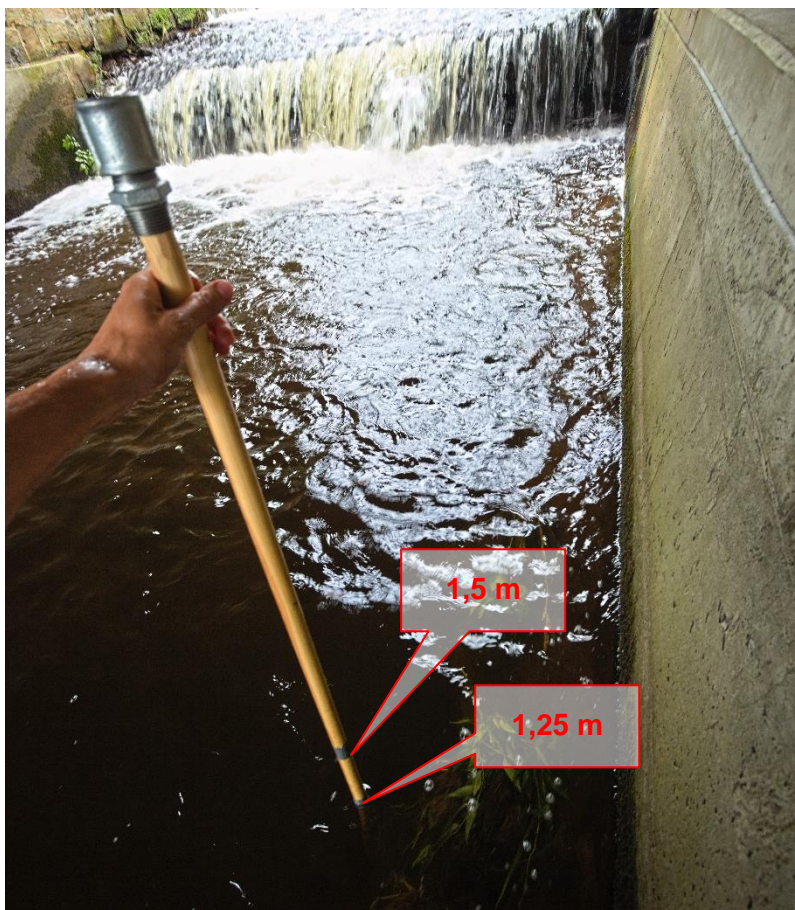
Obrázek 17 Hloubka výmolu při levém břehu pod mostem
